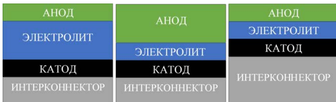
Рисунок 1.4 – Схематическое изображение ТОТЭ с разным типом поддерживающих элементов. Слева направо: электролит- и анод-поддерживающие конструкции, конструкция с внешней поддержкой.
