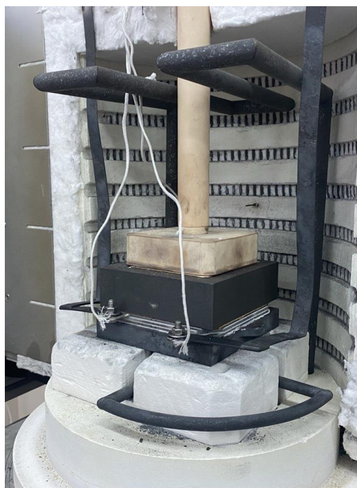
Рисунок 2.6 – Сборка электролит-поддерживающих ТОЭ, помещенная в испытательный стенд.
