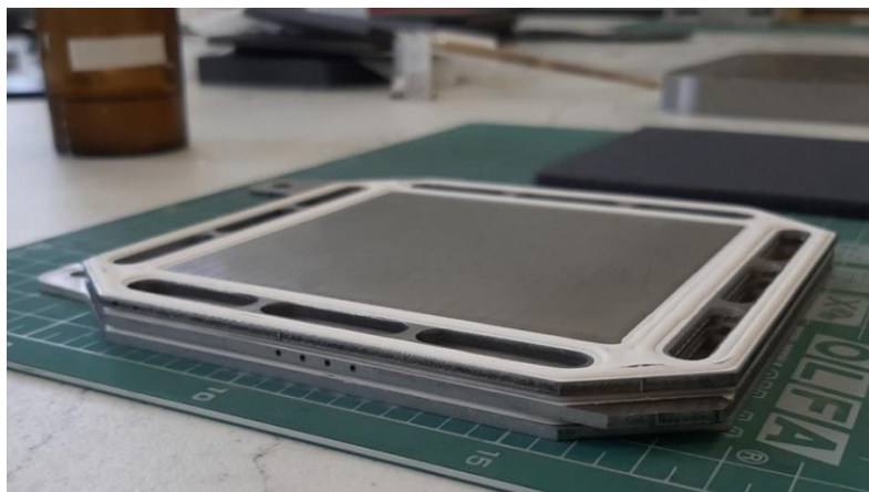
Рисунок 2.5 – Фотография сборки из 2 МЭБ.
