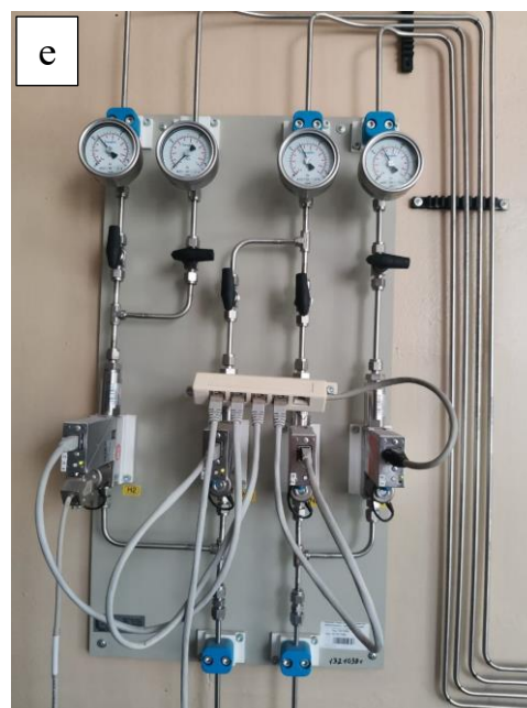
Рисунок 16 – Испытательный стенд для проведения электрохимических измерений единичных ТОТЭ диаметром 21 мм: (а) испытательная ячейка, (б) центральная прокладка из термикулита, уложенная на образец, (в) печь-книжка, (г) измерительной оборудование, (д) контроллер температуры печи, (е) газовый стенд.
