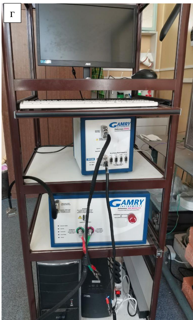
Рисунок 16 – Испытательный стенд для проведения электрохимических измерений единичных ТОТЭ диаметром 21 мм: (а) испытательная ячейка, (б) центральная прокладка из термикулита, уложенная на образец, (в) печь-книжка, (г) измерительной оборудование, (д) контроллер температуры печи, (е) газовый стенд.
