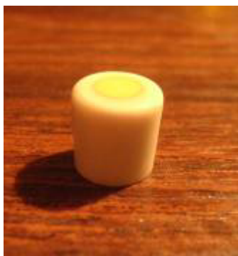
Рисунок 2 – Герметичное соединение диоксида циркония и алюмомagneзиальной шпинели
