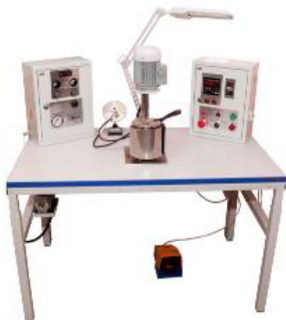
Рисунок 1 – Установка горячего шликерного литья ЭКОН - УГШЛ
