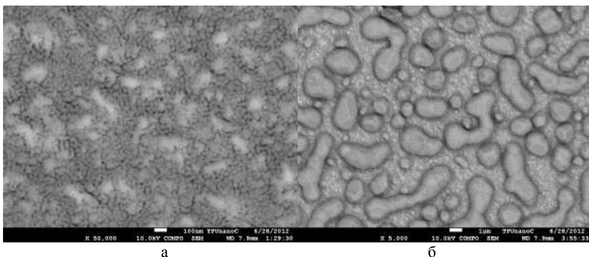
Рис.1. Снимок СЭМ поверхности восстановленного анода
