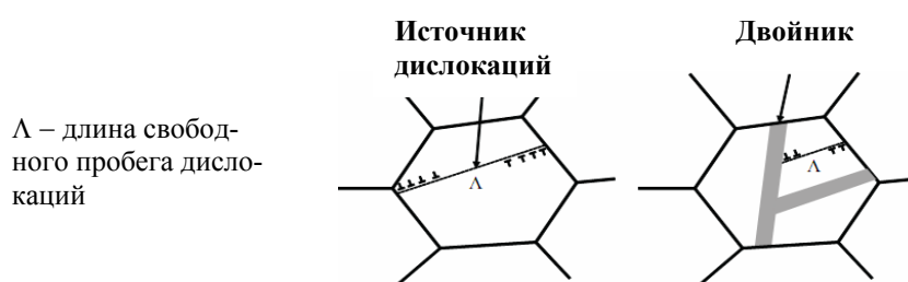
Рис. 1. Иллюстрация динамического эффекта Холла-Петча
